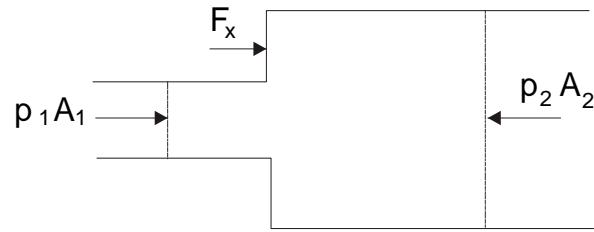
$$\sum F_x = \dot{m}_o V_{x,o} - \dot{m}_i V_{x,i}$$
