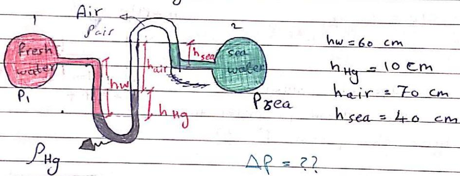
$$P_1 + \rho_w g h_w - \rho_{\text{Hg}} g h_{\text{Hg}} - \rho_{\text{air}} g h_{\text{air}}$$
