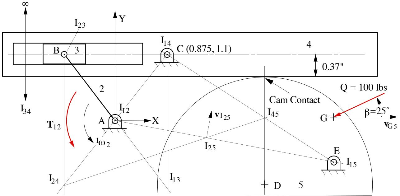
$$\frac{\|\omega_5\|}{\|\omega_2\|} = \frac{\|I_{25}/I_{12}\|}{\|I_{25}/I_{15}\|} \quad (4)$$
